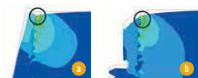
Bild 2: Spannungsreduzierung durch 45 Grad Konuswinkel; a) kleiner Konuswinkel, b) 45° Konus
